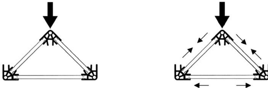
Fig. 27 - Une force appliquée à l'angle d'un triangle
